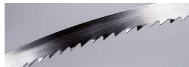
Nr. 23 4 Z"/; 13 x 0,50 mm Schrägzahn / geschränkt mit Räumzahn
