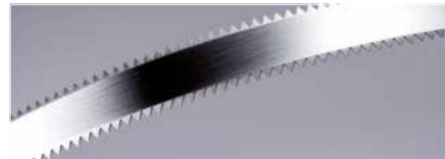
Nr. 44 | 10 Z"/; 15 x 0,45 mm C100S | Doppeldachzahn
